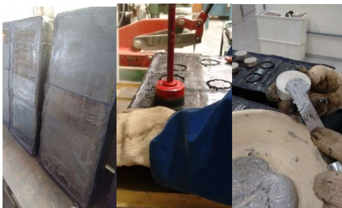
Figura 5: Preparo para teste de aderência
