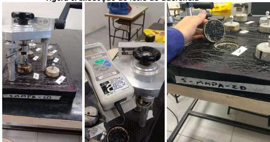
Figura 6: Execução de teste de aderência
