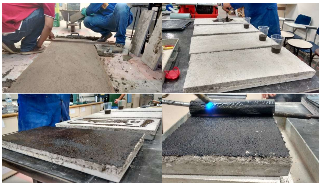
Figura 3: Regularização e aplicação do sistema de manta nas placas
